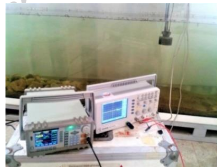
شکل ۲ تراگذارها در آب به همراه دستگاه‌های تولید و دریافت امواج صوتی.
