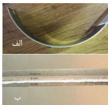
شکل ۲- نمونه‌های ورق سه‌لایه فلزی تولید شده به روش اتصال دهی نورد سرد (ب) سطح مقطع ورق سه‌لایه فلزی St 321/AA 1020/AA 5456
