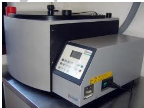
نگاره ۱- نمایش دستگاه هضم میکرو ویو Speed wave 4 مورد استفاده جهت آماده سازی نمونه‌های روغن ماهی
