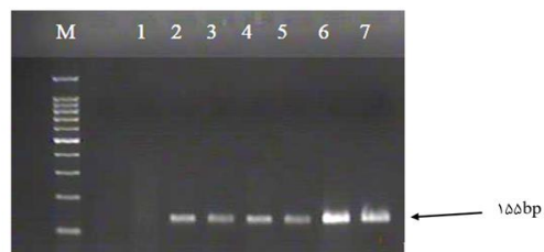
نگاره ۳- تصویر ژل الکتروفورز محصولات PCR ۶ سویه لاکتوکوکوس لاکتیس که از نظر حضور ژن nisin A مورد بررسی قرار گرفته اند. (ستون M: مارکر ۱۰۰ جفت بازی، ستون ۲-۷: محصول PCR ژن nisin A. ستون ۱: کنترل منفی)
