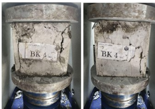
شکل (۳): تبدیل شکست از حالت ترد به نرم، منبع: نگارندگان، ۱۴۰۰
