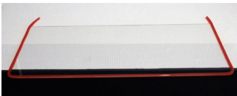
شکل ۴: شیشه پشت‌نما با نوار ضدنشست بسته شده که در هنگام عکس برداری از ژل در پایین قرار می‌گیرد Fig. 4: Transparent glass is closed with a tape that is placed at the bottom when shooting the gel
