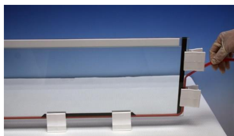
شکل ۱۱: جداکردن نوار ضدنشست و گیره‌ها بعد از پلیمریزاسیون ژل
