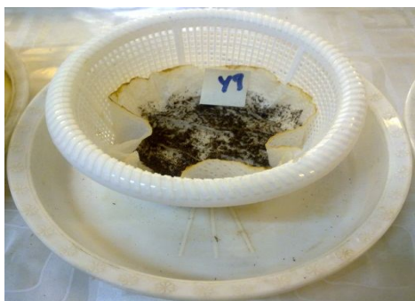
شکل ۴- خاک شستشو شده با فنویک حاوی سیست
