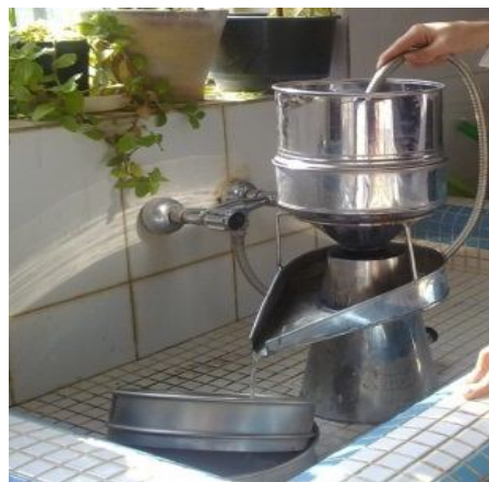
شکل ۳- خاکشویی با دستگاه فنویک
