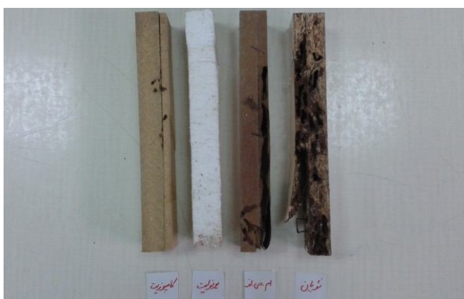
شکل ۴- خسارت و تغذیه موربانه M. diversus از مواد ساختمانی در آزمون صحرایی
