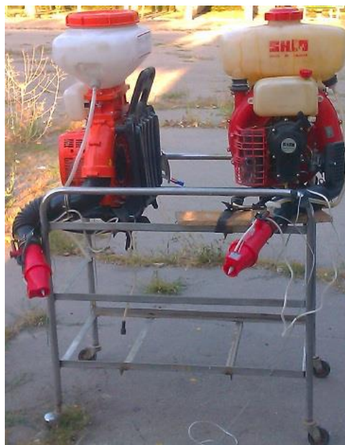
شکل ۱. چهارچرخ حامل سیستم سمپاش الکترواستاتیک
