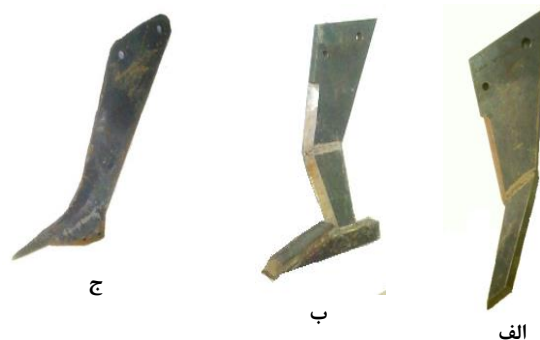
شکل ۱- الف تیغه کج ساق، ب- تیغه پاراپلو، ج- تیغه مرسوم
