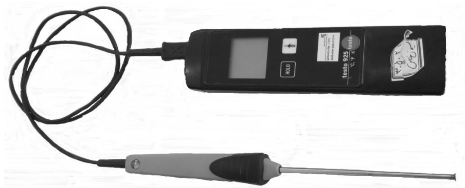
شکل ۶. ترموکوپل تماسی برای اندازه‌گیری دمای آفت
