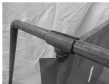
شکل ۳. نحوه حرکت افقی صفحات متراکم‌کننده بر روی قاب دستگاه
