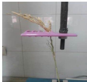
شکل ۳- شانه در هنگام جدا کردن دانه از خوشه.
