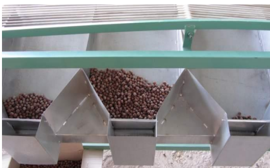
شکل ۳. تصویر فندق‌های اندازه‌بندی شده توسط دستگاه ساخته شده.
