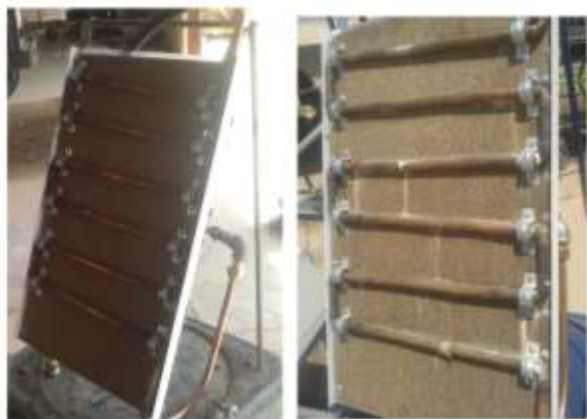
شکل ۴. تصویر سمت چپ: مبدل حرارتی قبل از آزمایش، تصویر سمت راست: مبدل حرارتی بعد از آزمایش
