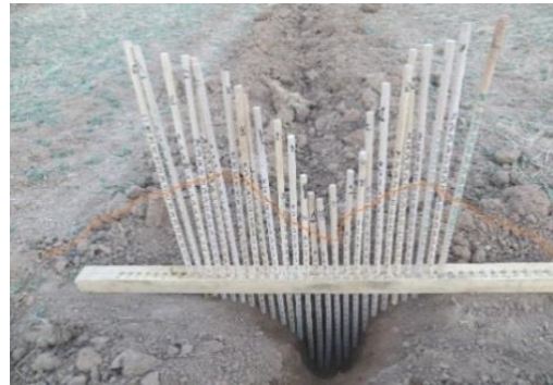
شکل ۶- اندازه‌گیری مساحت سطح بالا آمدگی خاک توسط پروفیل متر
