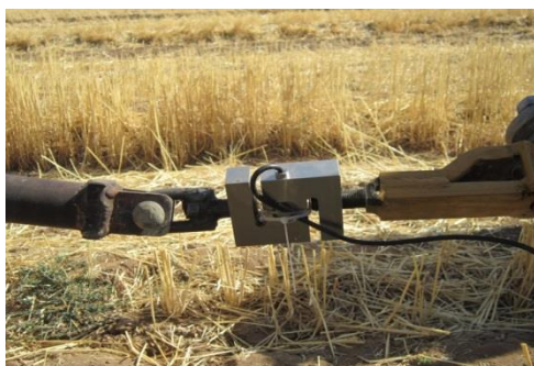
شکل ۱. الف نصب بارسنج بین دو تراکتور
