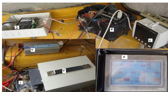
شکل ۴. اجزای واحد کنترل کننده سامانه الکتروهیدرولیکی
