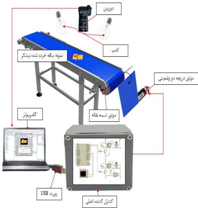
شکل ۴. شماتیک دستگاه جداسازی گره و میانگره
