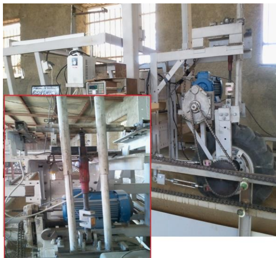
شکل ۲. لودسل ها و مجموعه داده برداری و نحوه عبور چرخ از روی مانع و اجزای آزمونگر تک چرخ
