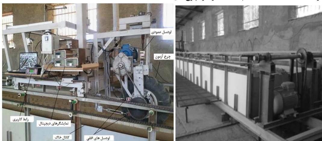
شکل ۱. مجموعه انباره خاک و آزمونگر چرخ به همراه ترانسیدویوسرها و سامانه جمع آوری و ثبت داده
