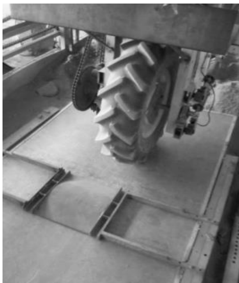
شکل ۲. لودسل ها و مجموعه داده برداری و نحوه عبور چرخ از روی مانع و اجزای آزمونگر تک چرخ
