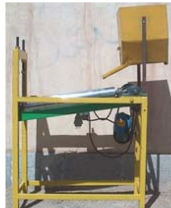
شکل ۱- دستگاه اندازه‌بند غلتکی ساخته شده و قسمت‌های مختلف آن: (۱) مخزن، (۲) سینی جمع‌آوری محصول، (۳) یاتاقان واحد انتقال قدرت،
