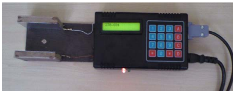
شکل ۳- دستگاه توزین تخم مرغ ساخته شده Fig.3. The built system for eggs weighing
