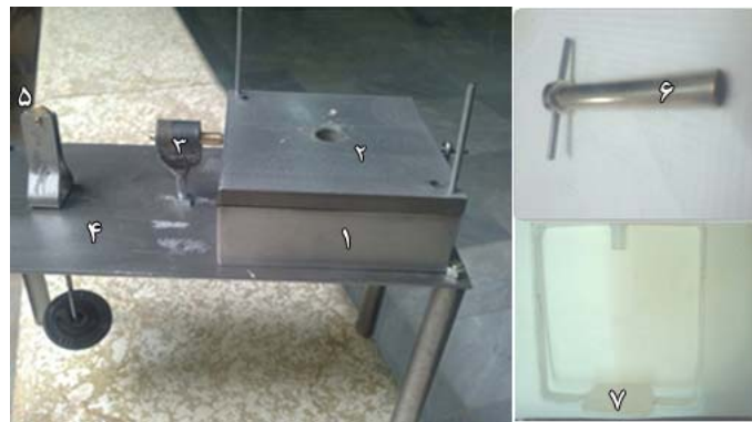
شکل ۳- قسمت‌های مختلف دستگاه برش مستقیم میوه: (۱) فک پایینی، (۲) فک بالایی، (۳) راهنما، (۴) میز کار، (۵) قرقره، (۶) نمونه‌گیر و (۷) محل قرارگیری وزنه
