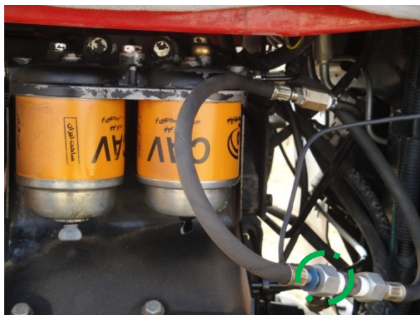
شکل ۳- محل نصب حسگر سوخت سنج
