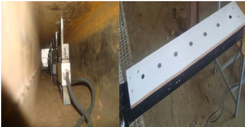
شکل ۲- سامانه اندازه‌گیری تنش زیر چرخ محرک با درپوش از جنس MDF با سوراخ‌کاری‌های مورد نیاز برای نصب لودسل Fig.2. Stress measuring transducer with MDF cover pierced at different positions to hold the required load cells
