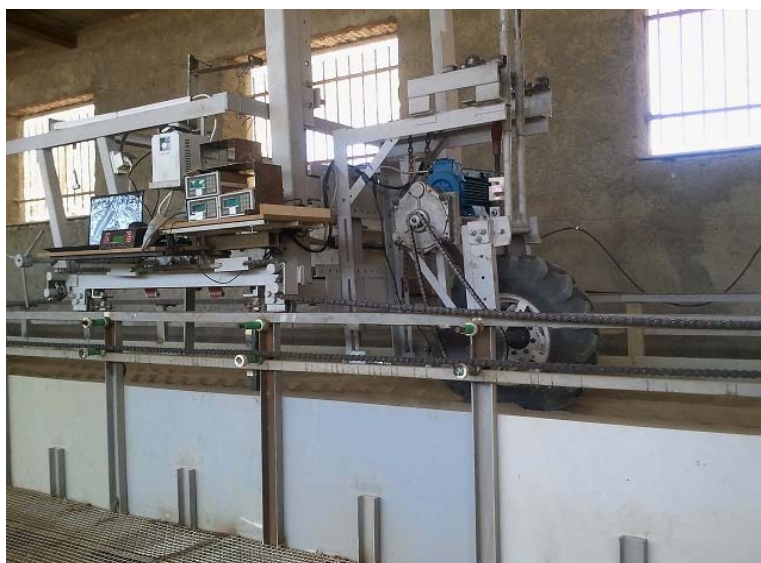
شکل ۱- شماتیکی از مجموعه‌ی انباره‌ی خاک و آزمونگر تک چرخ مورد استفاده در آزمایشات Fig.1. Schematic diagram of the soil bin and single-wheel tester being applied
