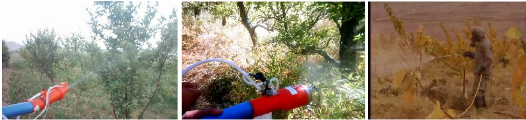
شکل ۱- سمپاش لانس دار (راست)، سمپاش میکرونر (وسط) و سمپاش الکترواستاتیک (چپ) Fig.1. Electrostatic (Left), Microner (Middle) and Lance Sprayers (right)
