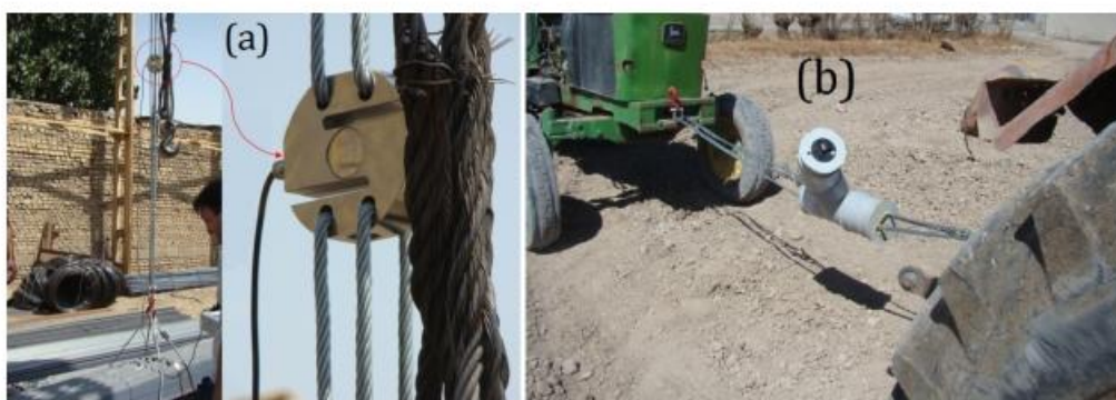
شکل ۳- (a) روش مورد استفاده در واسنجی نیروسنج سامانه (b) روش RNAM در اندازه‌گیری مقاومت کششی گاوآهن
