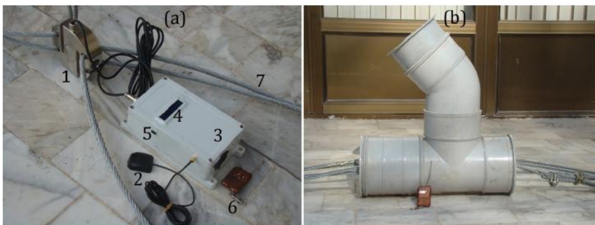
شکل ۱- (a) اجزاء به کار رفته در دینامومتر توسعه یافته (۱: لودسل نوع S، ۲: آنتن GPS، ۳: سامانه جمع‌آوری داده، ۴: نمایشگر، ۵: کارت حافظه، ۶: کنترل‌کننده از راه دور، ۷: کابل‌های اتصال) (b) اجزاء جمع شده دینامومتر در لوله محافظتی دارای فوم
