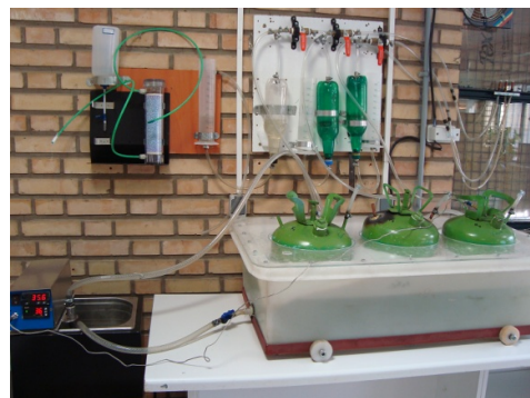
شکل ۱- راکتورهای آزمایشی، تجهیزات اندازه‌گیر حجم گاز و حمام آب گرم
