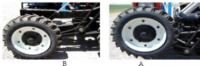
شکل ۵- چرخ جداگانه محرک موزع، A: در حین حمل و نقل (بالا)، B: چرخ محرک موزع در تماس با زمین
