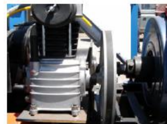
شکل ۳- سیستم نیوماتیکی محرک چک‌های شیاربازکن‌ها Fig.3. Pneumatic system for actuating cylinders of openers
