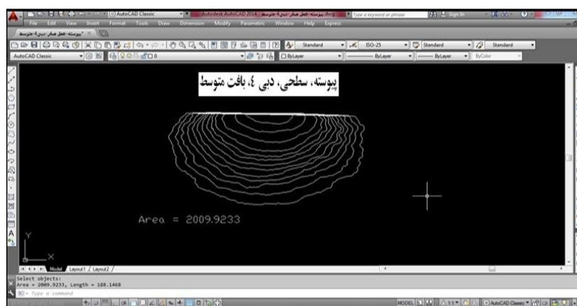
شکل ۴- محاسبه مساحت خیس‌شدگی پیاز رطوبتی در زمان‌های مختلف حین آبیاری با استفاده از نرم‌افزار اتوکد.
