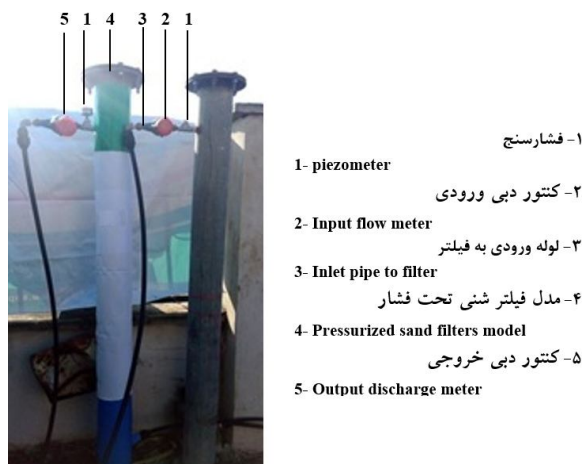
شکل ۱- نمایی از مدل فیلتر شنی تحت فشار با محتویات سیلیس.
