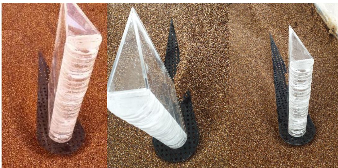
شکل ۹- تصاویری از آب‌شستگی.
