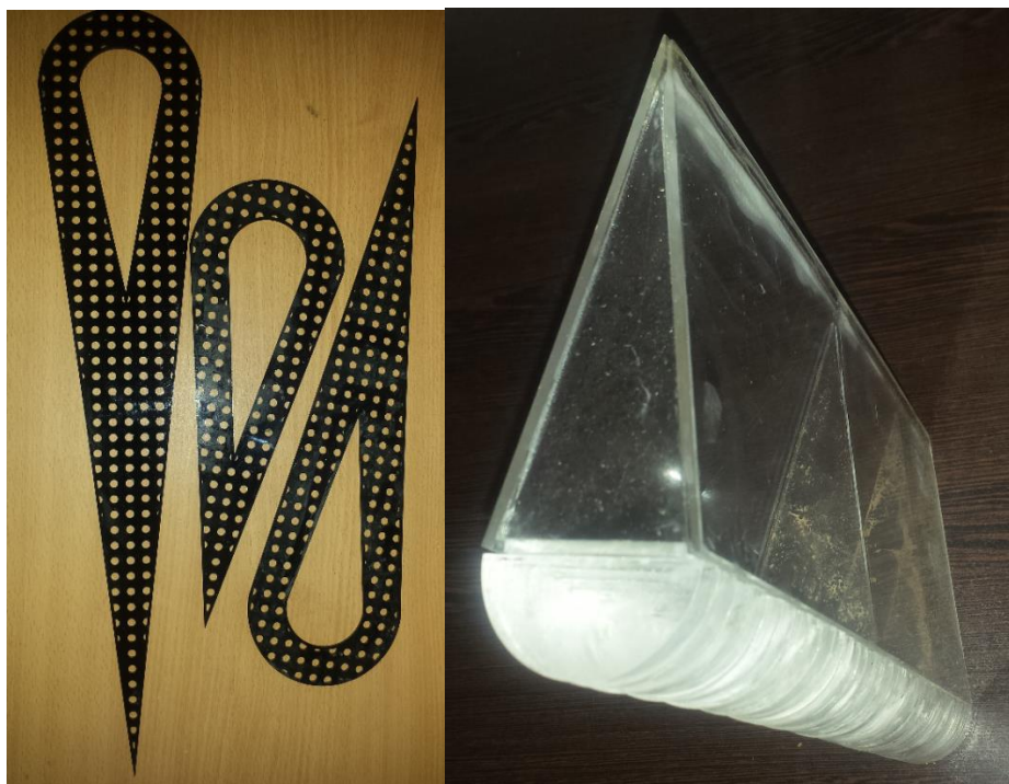
شکل ۴- طوقه و پایه پل آنرویدینامیک ساخته شده.
