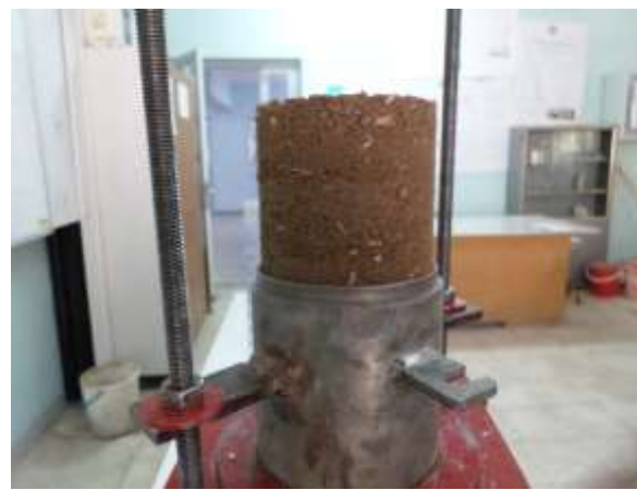
شکل ۱- مخلوط مالچ و خاک و تست پراکتور
