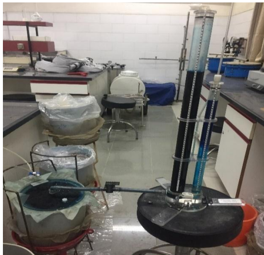
شکل ۲- نحوه تزریق ماده ردیاب رنگی به خاک توسط دستگاه نفوذسنج مکشی
