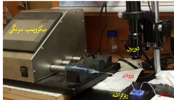
شکل ۳) ریزتراشه متصل به میکروپمپ سرنگی
