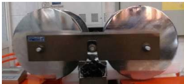
شکل ۱- دستگاه مولد میدان مغناطیسی ایستا
