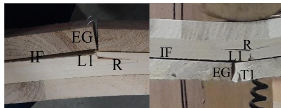
ب: مدهای شکست در جهت عرضی پانل CLT
