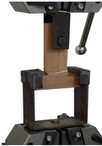
شکل ۳- نحوه بارگذاری بر اتصال‌های ساخته‌شده
