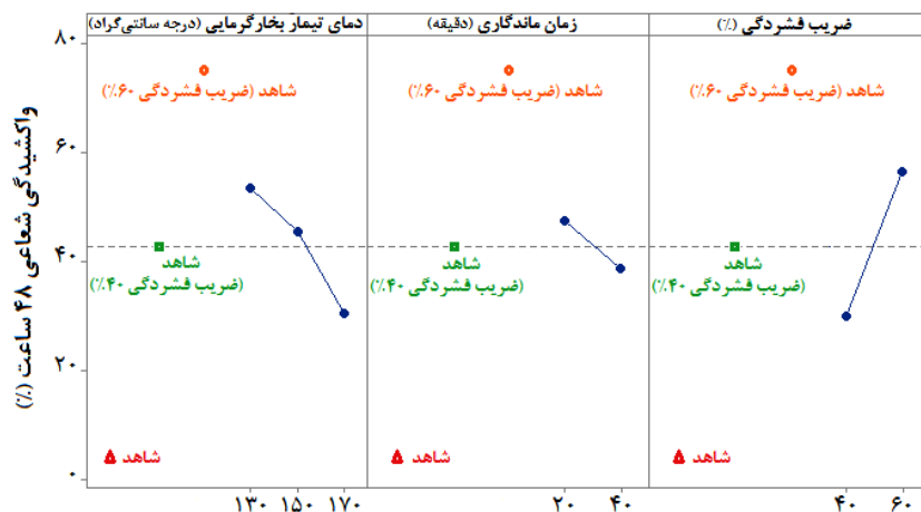
شکل ۷- تأثیر دمای تیمار بخار گرمایی، زمان ماندگاری و ضریب فشردگی بر واکسیدگی شعاعی (واکسیدگی در راستای فشردگی) ۴۸ ساعت گلولام
