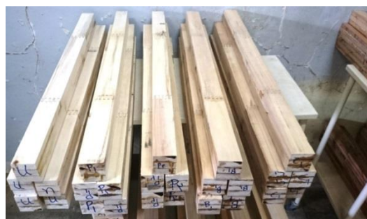
شکل ۵- نمونه‌هایی از گلولام‌های ساخته‌شده از چوب صنوبر تیمار شده با فرایند بخار گرمایی مکانیکی
