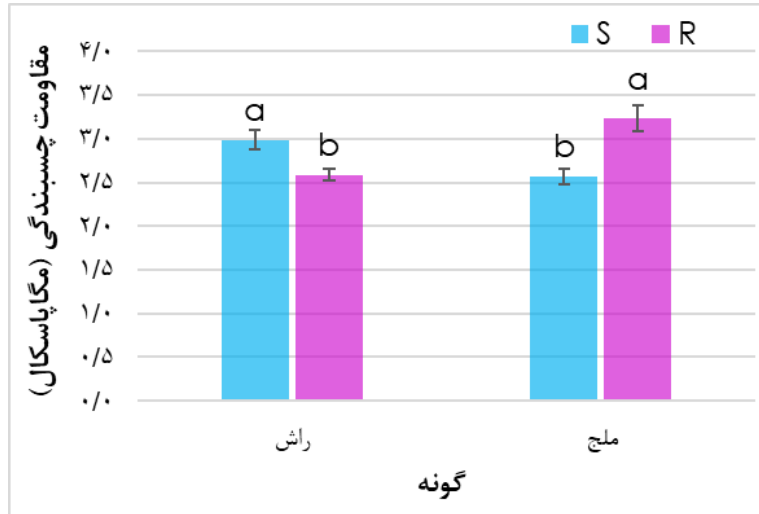
شکل ۳- اثر متقابل نوع روکش و توالی پرداخت بر مقاومت چسبندگی
