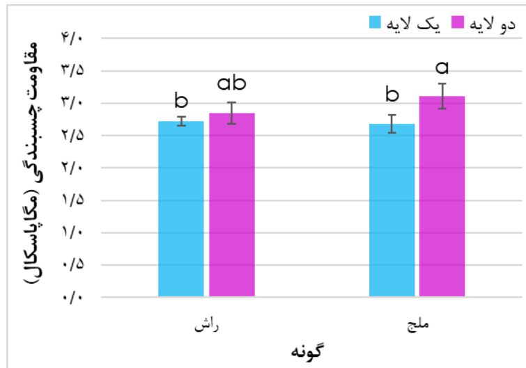
شکل ۴- اثر متقابل نوع روکش و ضخامت پوشش بر مقاومت چسبندگی
