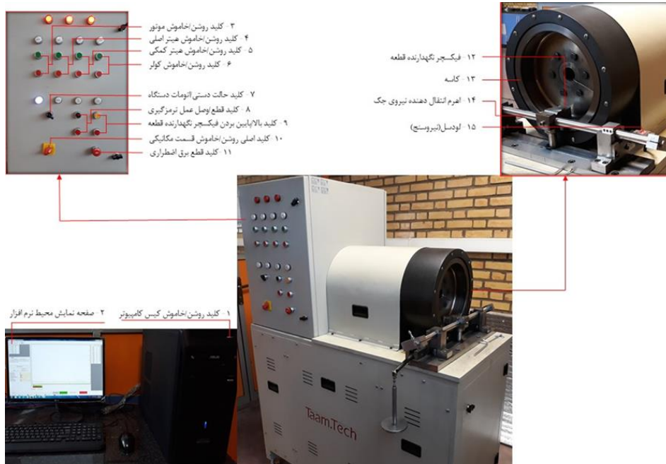
شکل ۴. دستگاه آزمون سایش و اصطکاک لنت ترمز
