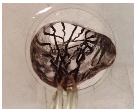
ب- نمای لوله برای اندازه‌گیری فشار سطح شکل ۳- لوله بادامکی برای مطالعه درگ فشاری
