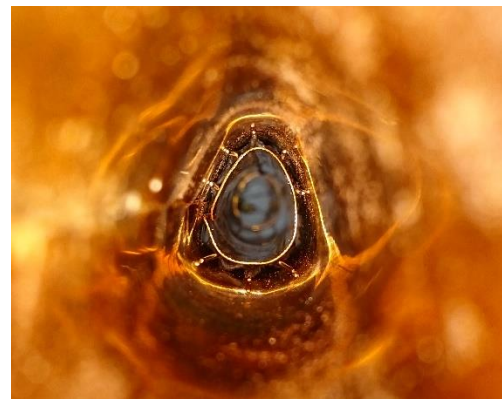
ب- نمای داخلی لوله پیش از قرار گیری هسته شکل ۴- بادامکی برای مطالعه انتقال حرارت
