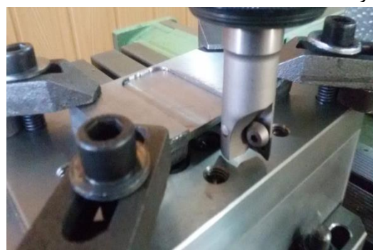
شکل ۲-۵- بستن ابزار، قطعه و انجام تنظیمات لازم.
