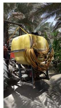
شکل ۲. سمپاش لانس دار پشت تراکتوری (راست)، لانس و بوم ۴ متری (وسط)، محل نصب کارت‌های حساس (چپ)
