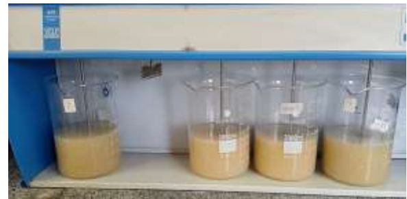
شکل ۱. پایلوت مورد استفاده جهت انعقاد فاضلاب لینی
