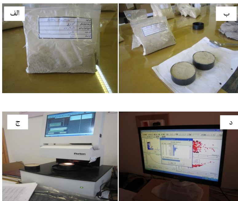
شکل ۱. مراحل مختلف انجام کالیبراسیون با دستگاه NIR و ایجاد مدل‌های کالیبراسیونی
