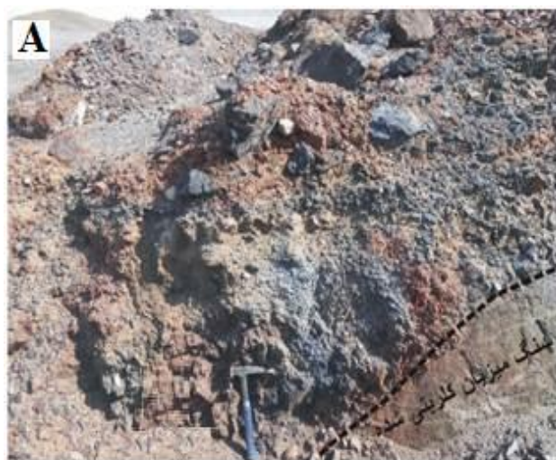
شکل ۶- تصویر صحرایی از متاولکانیک‌های منطقه. (A) سنگ میزبان که دگرسانی کلریتی نیز نشان می‌دهد و کمر پایین ماده معدنی را می‌سازد؛ (B) برشی شدن در سنگ‌های متاولکانیک منطقه در نزدیکی ماده معدنی
