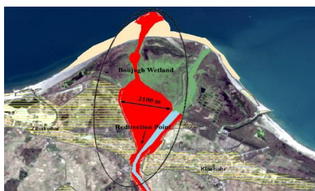
شکل ۹ - پیش‌بینی تغییرات مورفولوژی کانال رودخانه سفیدرود و محدوده تحت مخاطره کیشهر - تالاب
