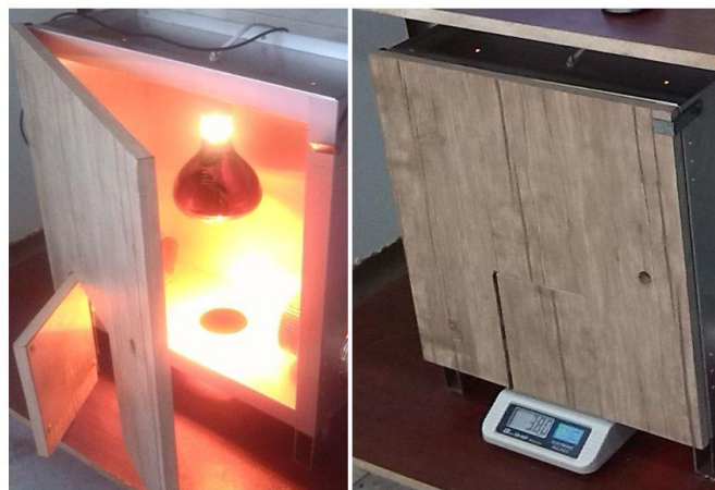
شکل ۱- خشک‌کن مادون‌قرمز مورد استفاده در این تحقیق
