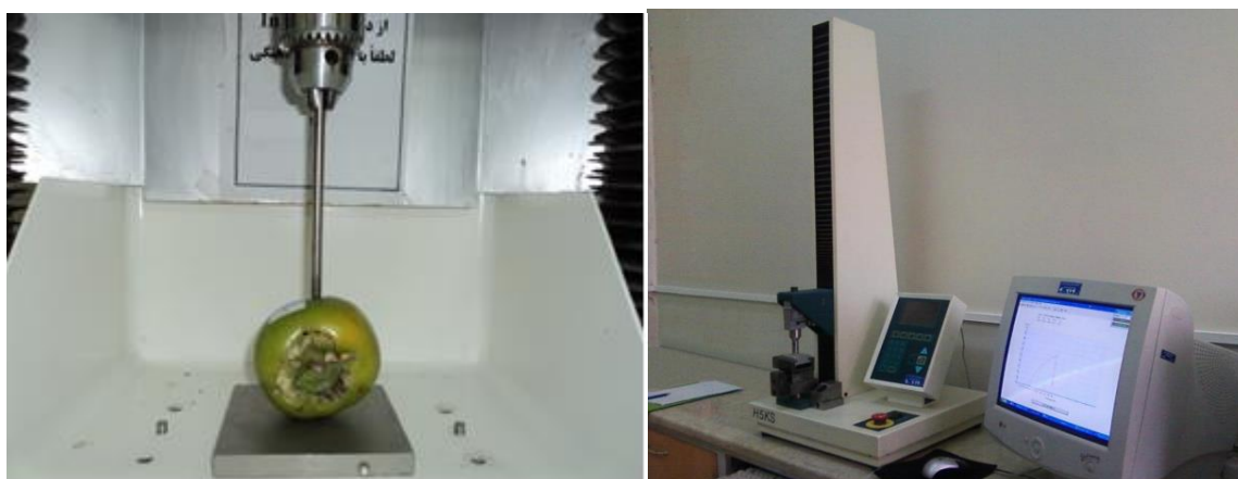
شکل ۱- دستگاه هانسفیلد (سمت چپ)، نحوه انجام آزمایش‌ها (سمت راست)
