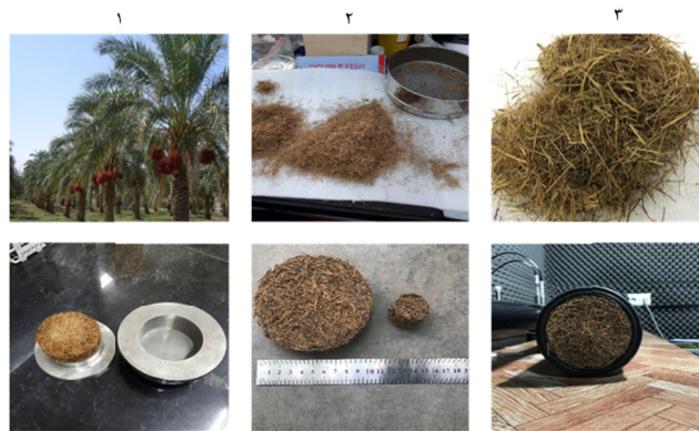
شکل ۱- مراحل آماده سازی الیاف طبیعی نخل خرما جهت تعیین ضریب جذب آکوستیکی
